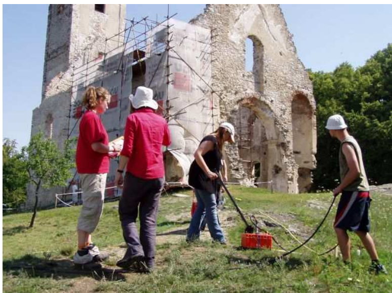
Obr. 7 Geofyzikálny výskum areálu kláštora sv. Kataríny - meranie georadarom. Foto I. Kvetánová, 2009
